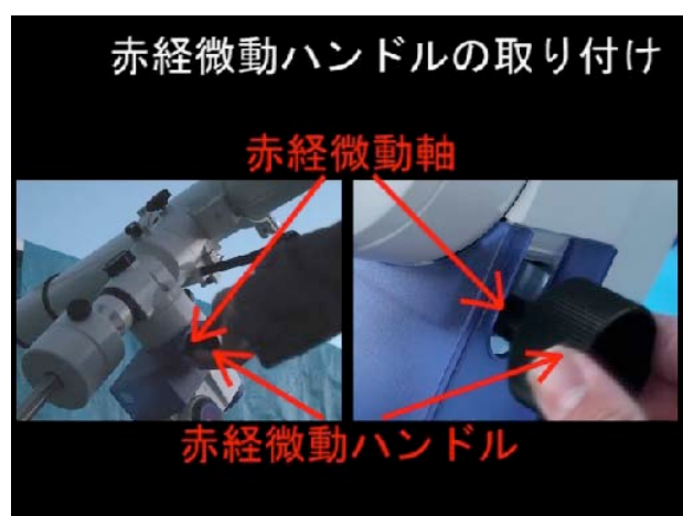
図3 赤経微動ハンドルの取り付け
