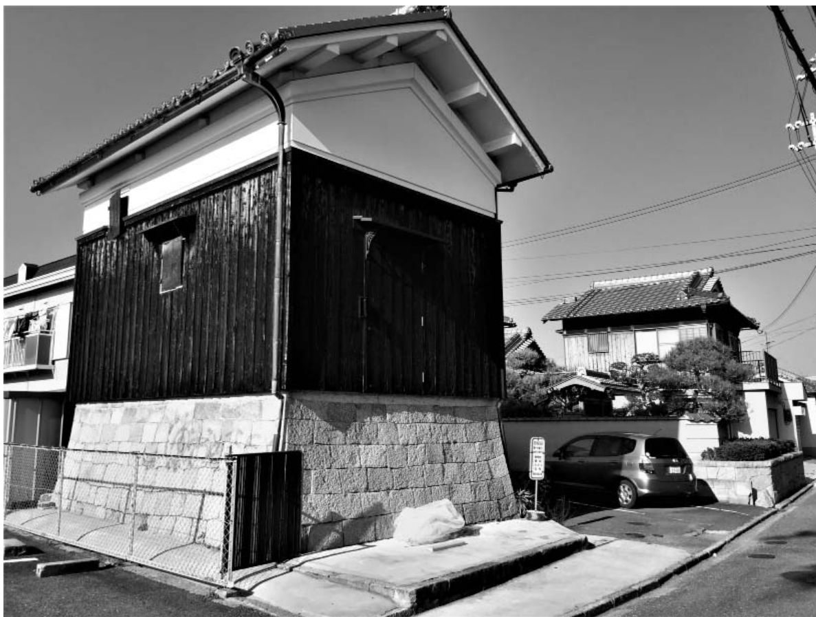
図6 石垣によってかさ上げされた蔵の事例
